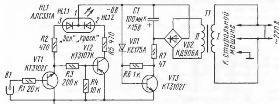
Как только бак машины будет заполнен водой настолько, что штырь датчика В1 соединится (через проводящую ток воду) с корпусом, транзистор VT1 откроется и светодиод HL1.1 загорится. Транзистор же VT2 закроется, и светодиод HL1.2 погаснет. Таким образом, зажигание зеленого светодиода HL1.1 сигнализирует
