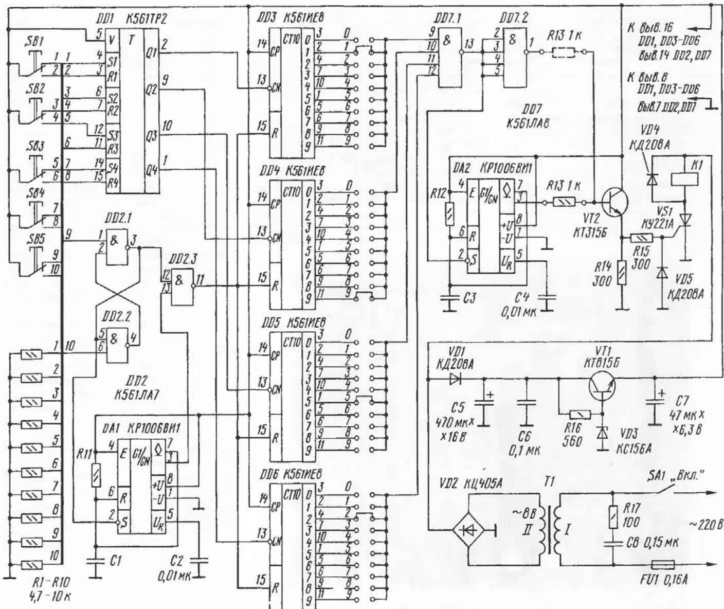
тыре части. Первая — блок набора кода (элементы DD1, DD3—DD6, DD7.1); вторая — элементы установки счетчиков в исходное состояние и таймер (DD2.1—DD2.3, D1); третья часть — исполнительная (элементы DA2, VT2,
